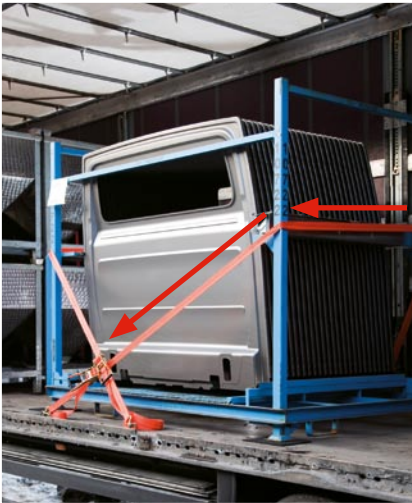
Schrägverzurrung: RHM-Matten und die senkrechte Sicherungskomponente der Verzurrung verhindern ein seitliches Wandern der Ladung.
