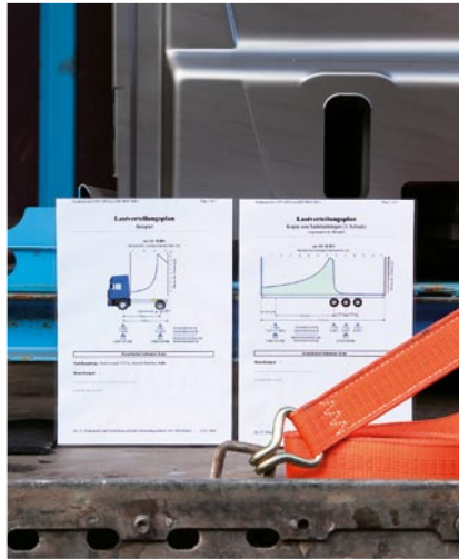
Entscheidungshilfe Lastverteilungsplan: Achslastüber- oder -unterschreitung beeinträchtigt das Fahr-, Brems- und Lenkverhalten des LKW.
