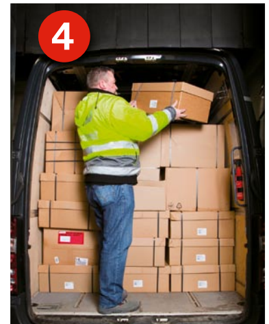
4 Planen: Beim Beladen auf Lastverteilung, Formschluss, Gewicht (Schweres runter, Leichtes rauf) und den Tourenplan achten.
