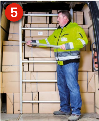
5 Richtig sichern: Der Fahrer muss so sichern, dass die im Fahrbetrieb auftretenden Kräfte von der Karosserie aufgenommen werden können.
