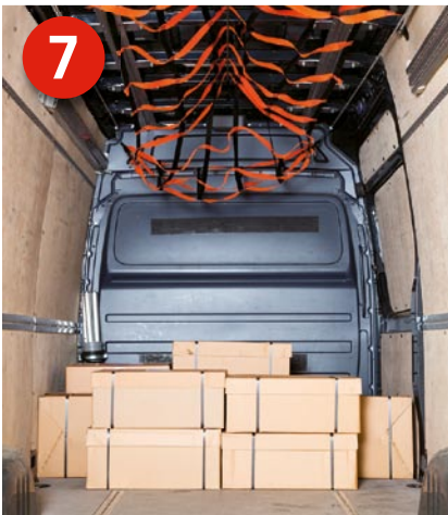
7 Teilladung: Die Fracht wurde teilweise ausgeliefert. Der Beladezustand hat sich geändert. Die Ladungssicherung muss neu angepasst werden.
