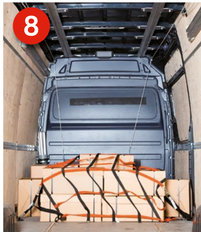
8 Neu gesichert: Der Ladeschwerpunkt hat sich nach vorne verlagert. Mit Hilfe des Sicherungsnetzes ist die Teilladung wieder sicher verladen.
