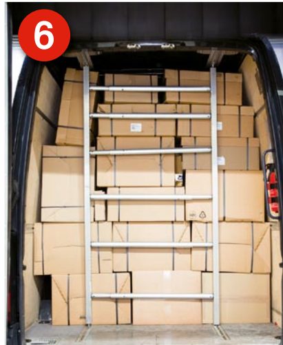
6 Abfahrbereit: Die Ladung ist in alle Richtungen gesichert. Die Sperrbalken verhindern, dass sich die Ladung verschieben kann.
