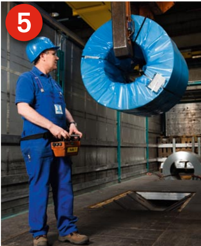
5 Weitere Ware: Es wird ein zweites Coil geladen. Aus Gründen der Lastverteilung können hier keine Steckungen verwendet werden.
