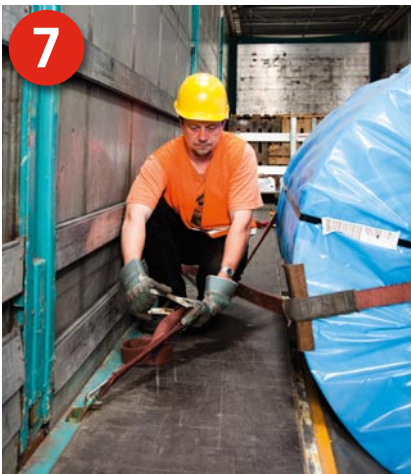
7 Zwei weitere Zurrgurte sichern das Coil gegen Verrutschen entgegen der Fahrtrichtung. Alle Gurte werden lediglich straff angezogen.
