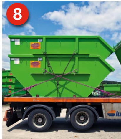
8 Gestapelte Behälter sind zu einer Ladeinheit zusammengefasst. Da der untere Behälter teilgefüllt ist, müssen zusätzliche Kräfte sichern.
