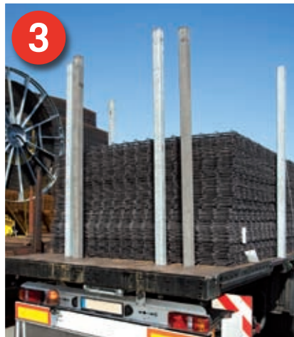
3 Formschluss: Auch nach hinten und zur Seite liegen die Betonstahlmatten formschlüssig an den Steckungen an.
