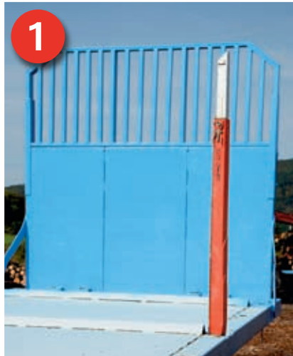
1 Geeignetes Fahrzeug (Beispiel) mit besenreiner Ladefläche, Keilleisten, Steckungen und einer ausreichend dimensionierten Stirnwand.
