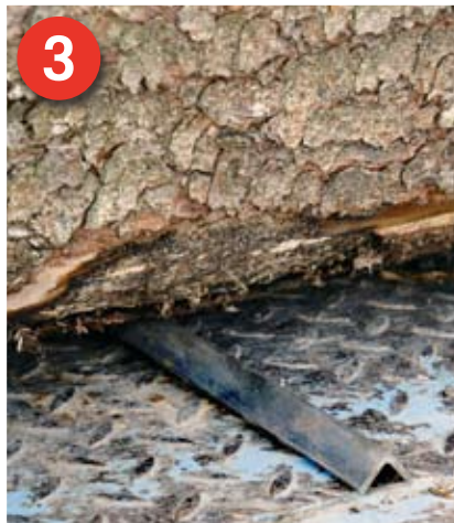
3 Keilleiste: Die unterste Lage des Rundholzes wird durch Keilleisten festgehalten. Alternativen sind Zahn- oder Stegleisten.
