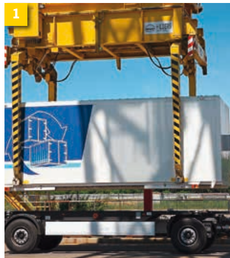
„Kombinovaná doprava s výměnnou nástavbou (1) nebo kontejnerem (2)“: Speciální nákladní vozy a přívěsy nebo speciální návěsy zajišťují příjezd do nakládacího terminálu a odjezd z terminálu. Převážná část přepravy (hlavní jízda) probíhá po železnici.
