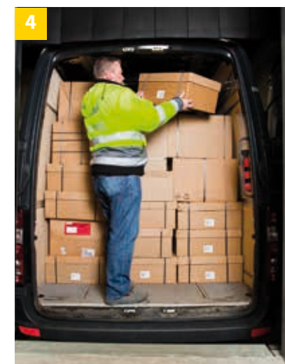
4 Plánování: Při nakládce dbejte na rozložení zátěže, tvarový styk, hmotnost (těžké dolů, lehké nahoru) a plán trasy.
