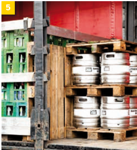
Různé zboží: Náklad je na přívěsu. Dbejte na to, aby horní sudy zcela stály na vlastních paletách.
