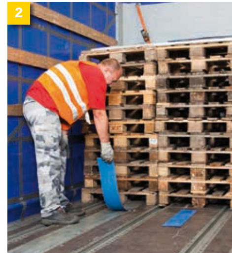
Správná vzdálenost: Aby bylo možné dodržet plán rozložení zátěže, byly na čelní stěně jako distanční držáky nastohovány prázdné palety.
