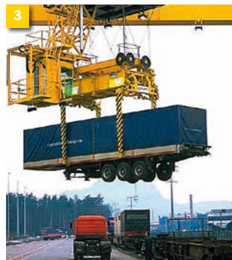
„Nedoprovázená kombinovaná doprava“: Celý návěs se bez tahače naloží na kapsové vagony.
