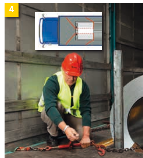
Nasad'te upevňovací prostředek (viz obrázek) a zajistěte s ním cívku proti sklouznutí dozadu a proti vyvalení do strany.
