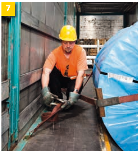
Dva další vázací popruhy zajišťují cívku proti sklouznutí proti směru jízdy. Všechny popruhy se pouze utáhnou, aby byly napnuté.
