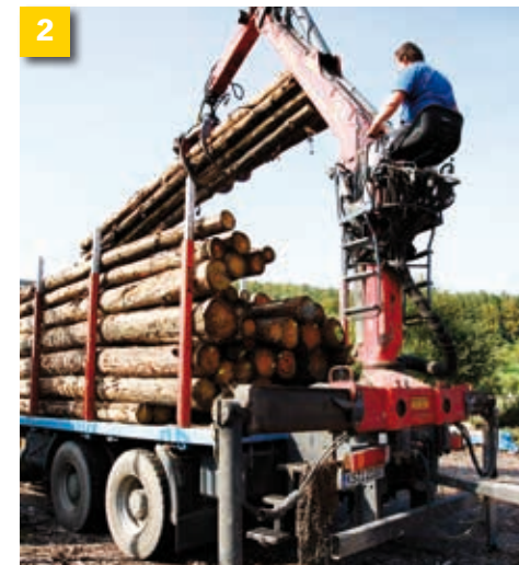
2 Ładunek: Załadunek drewna okrągłego dłuższego niż 4 metry. Załadunek przeprowadza się każdorazowo od zewnątrz do środka.
