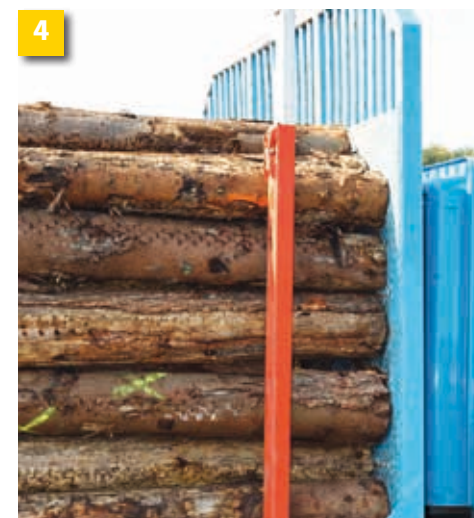
4 Załadunek zamknięty kształtowo: Ładunek przylega w kierunku jazdy do wystarczająco stabilnej ścianki czołowej.
