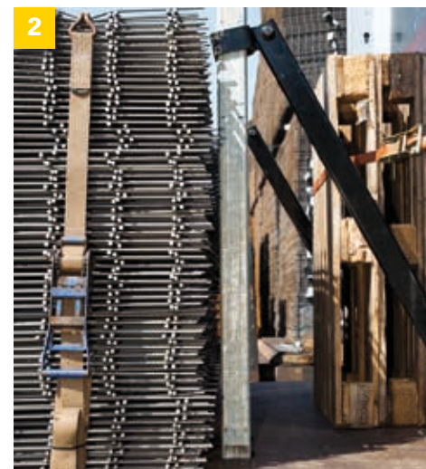
2 Podpory dodatkowe: W kierunku jazdy kłonicy wtykowe ze względu na większe obciążenia są dodatkowo podparte do przodu.
