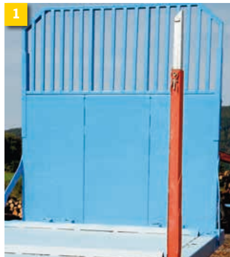
1 Odpowiedni pojazd (przykład) z uprzątniętą powierzchnią ładowania, listwami klinowymi, kłonicami wtykowymi i wystarczająco zwymiarowaną ścianką czołową.
