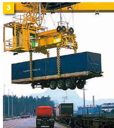
„Transport łączony bez asysty”: Tutaj cała naczepa siodłowa bez ciągnika siodłowego jest ładowana na specjalny wagon.
