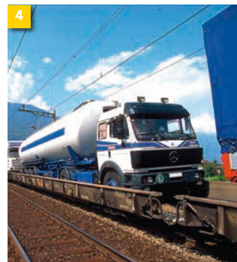
„Transport kolejowo-drogowy”: Kompletne pojazdy drogowo jeżdżą własnymi siłami na specjalnym wagonie niskopodłogowym kolei.
