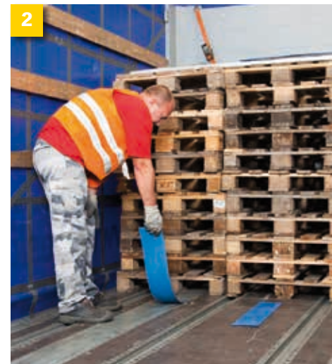
Właściwy odstęp: Aby możliwe było utrzymanie planu rozkładu obciążenia, puste palety zostały ułożone w stos jako element dystansowy przy ścianie czołowej.
