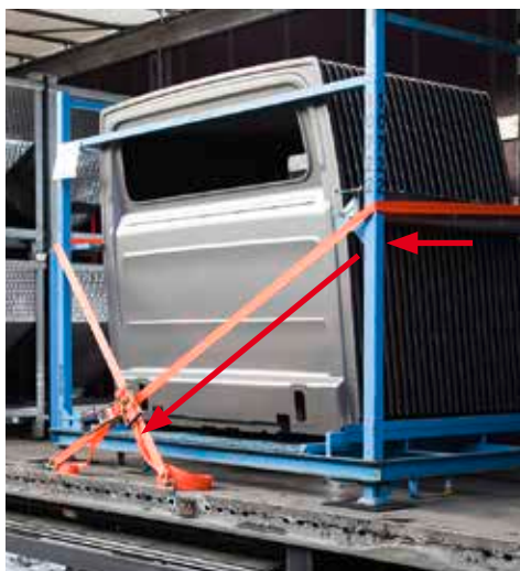
Mocowanie skośne: Maty RHM i pionowy komponent zabezpieczający mocowania uniemożliwiają boczne przemieszczanie się ładunku.
