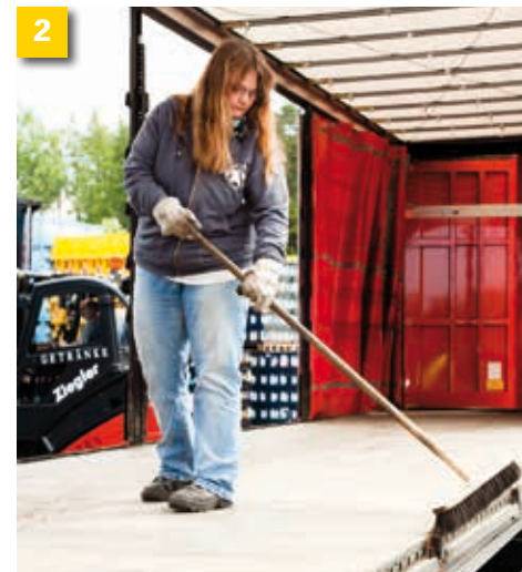
2 Condiție: trebuie să dispuneți de un vehicul adecvat (DIN EN 12642 cod XL pentru băuturi), iar platforma de încărcare trebuie să fie bine măturată.
