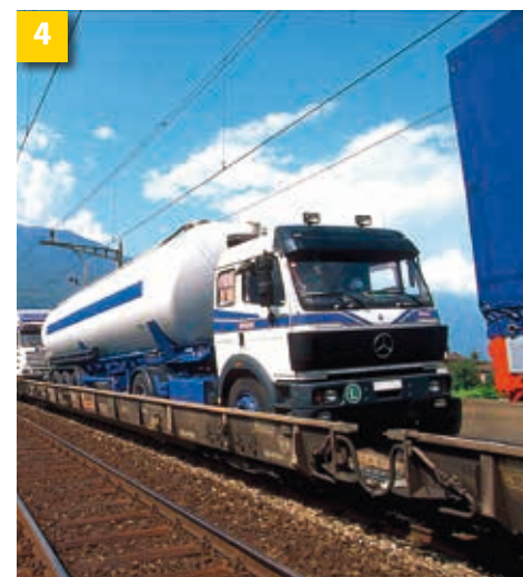
„Autostrăzi rulante”. Vehicule rutiere complete circulă cu forță proprie pe vagoane cu platformă joasă speciale.
