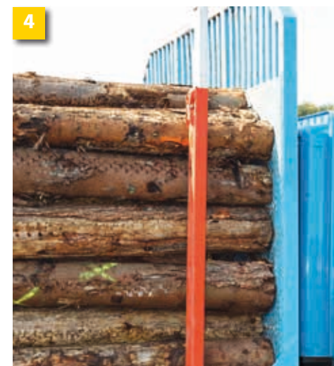
4 Încărcarea prin alinierea formei elementelor. Încărcătura este aliniată în direcția de mers la peretele frontal suficient de stabil.
