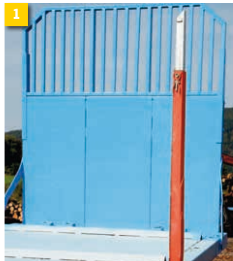
1 Vehicul adecvat (exemplu) cu platformă de încărcare măturată, bare tip pană, stâlpi de susținere și perete frontal dimensionat suficient.
