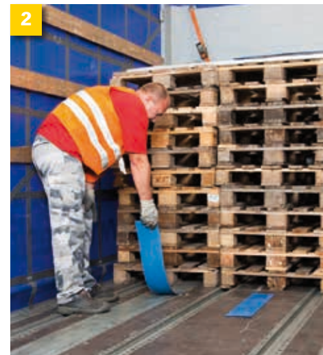
Distanța corectă: pentru a putea respecta planul de distribuție a sarcinii, au fost stivuite la peretele frontal paleți liberi pe post de distanțiere.
