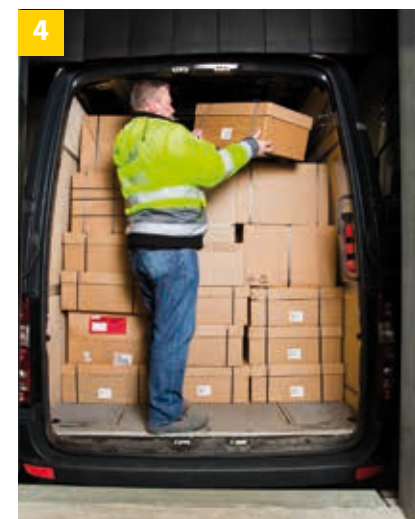
4 Planificarea: atunci când încărcăți bunurile, aveți în vedere distribuția sarcinii, contactul prin formă, greutatea (obiectele grele jos, cele ușoare sus) și planul rutei.
