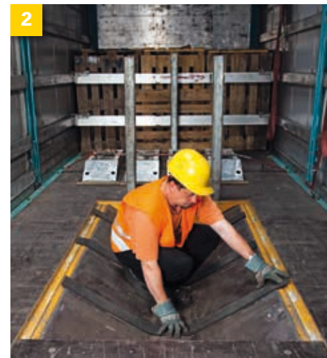
2 Primul pas: instalați covorașe antiderapante în benzi late de cel puțin 15 centimetri între bobină și fosa în care se așază bobina.
