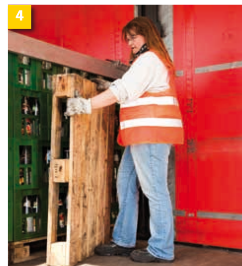
4 Asigurarea: conducătorul vehiculului așază paleți goi vertical lângă navele de băuturi, pentru a le proteja de butoiaie.
