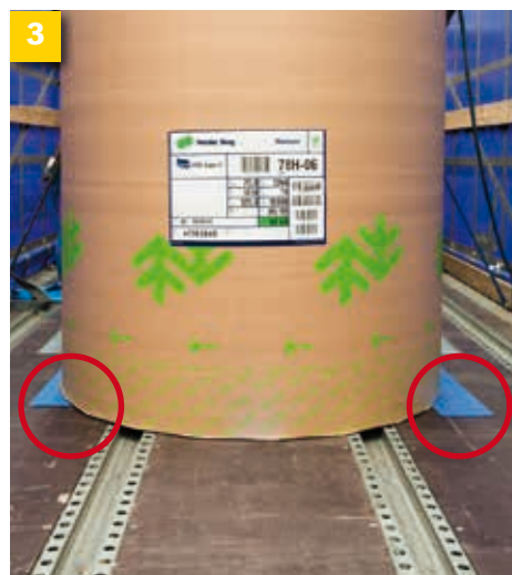
Așezați covorașe antiderapante la marginile rolelor. Acestea trebuie să iasă în afară minim 1 centimetru.
