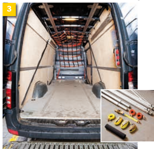
3 Mijloace ajutătoare pentru asigurarea încărcăturii: plasele pentru asigurarea încărcăturii au o utilizare universală. Barele de blocare și chingile de ancorare (imaginea mică) ajută la rândul lor la asigurarea încărcăturii.
