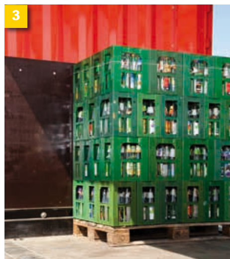
3 Încărcarea: încărcați întotdeauna navele de băuturi pe paleți aliniate la peretele frontal. Respectați întotdeauna planul de distribuție a sarcinii.
