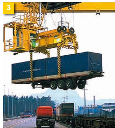
„Transportul combinat neînsoțit”. În acest caz, semiremorca completă fără autotractor este încărcată în vagoane speciale destinate semiremorcilor.
