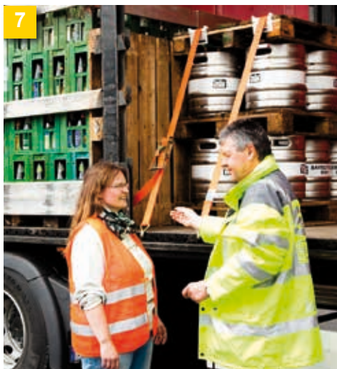
7 Готово: груз правильно размещен и закреплен, можно опустить брезент; автомобиль готов к отправлению.
