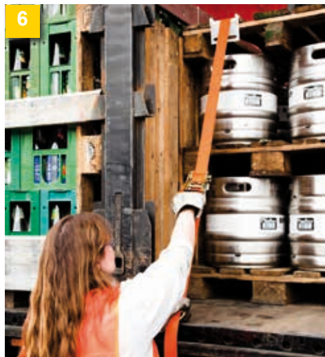
6 Стяжка: несмотря на использование сертифицированного прицепа (DIN EN 12642 Code XL для напитков) грузы на поддонах, уложенные штабелями, необходимо стягивать.
