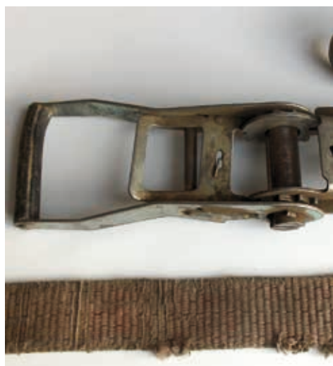
Определение непригодности: при надрезах (более 10 %) в ткани, отсутствии или неразборчивости этикетки, а также деформации трещотки ремень следует утилизировать.
