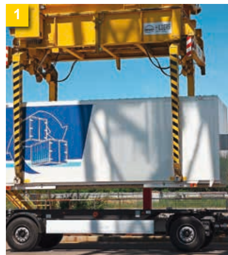
Трейлерные перевозки сменных (1) или грузовых контейнеров (2): грузы доставляются на терминалы и забираются с терминалов с помощью специальных грузовиков, прицепов или полуприцепов. Большая часть пути перевозки приходится на железную дорогу.
