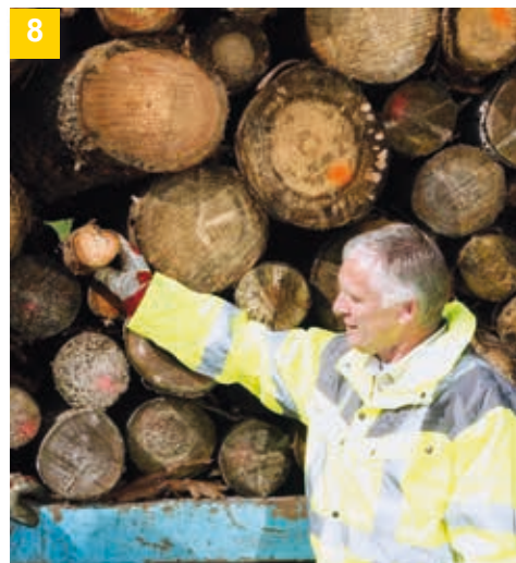
8 При перевозке бревен короче 4 м принимайте меры во избежание образования полостей. Иначе бревна из таких полостей могут выскользнуть из штабеля.
