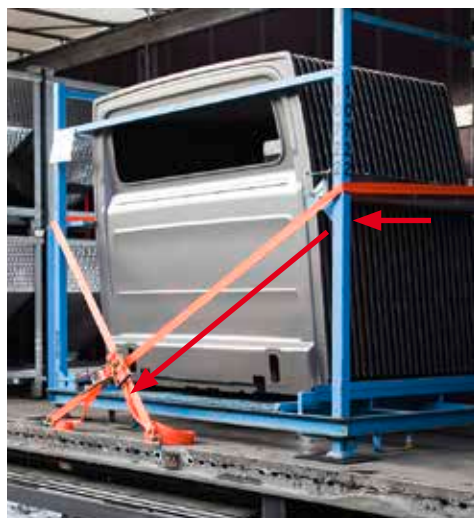
Якорное крепление: противоскользящие маты и вертикальный компонент крепления предотвращают смещение груза в сторону.
