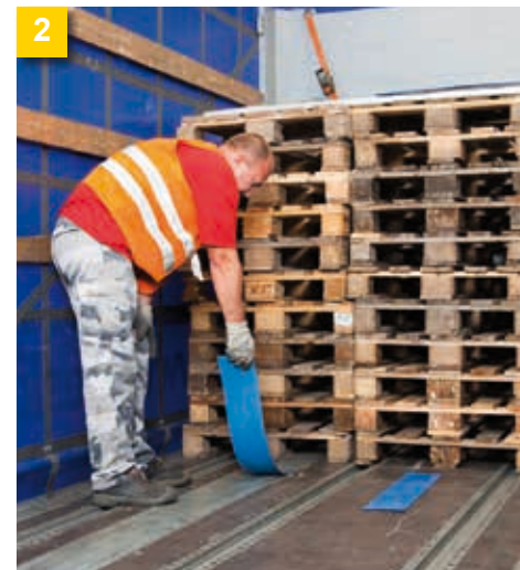
Правильное расстояние: для соблюдения схемы распределения нагрузки у торцевой стенки размещены поддоны.
