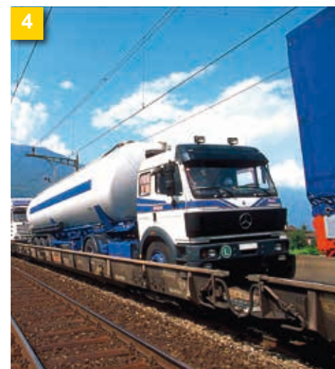
«Рельсовое шоссе»: загруженные автомобили своим ходом заезжают на специальные вагоны с пониженной платформой.
