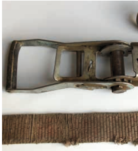
Tasfiye: Kumaşta kesikler varsa (%10'dan fazla) etiketler eksik veya okunaksız ise ve kayış cırcırları deforme olmuş ise bunları atın.
