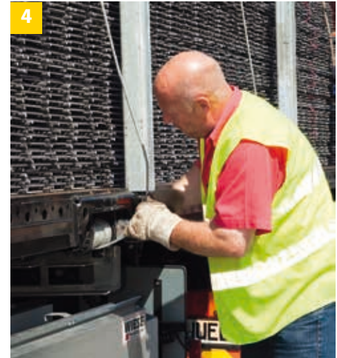
Hasırların yukarı doğru kalkmasını önlemek için aşağı bastırarak bağlama da yapılır. Dikkat, sadece güvenli çektirmeler kullanın!
