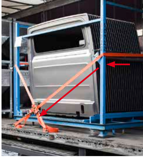
Çapraz bağlama: RHM matları ve bağlama parçasının dikey emniyet bileşeni, yükün yanlara doğru hareketini önler.
