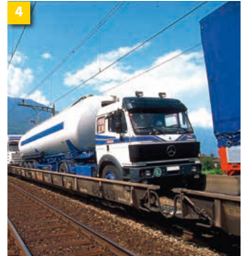
"Tekerlekli karayolu": Komple karayolu taşıtları, özel, alçak tabanlı tren vagonlarında taşınır.
