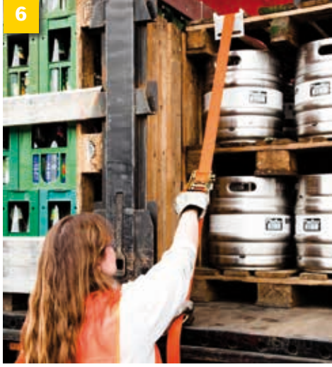
Bağlama: Sertifikalı treylere (meşrubatlar için DIN EN 12642 Kod XL) rağmen, istiflenmiş palet yükü aşağıya bastırarak bağlanmalıdır.
