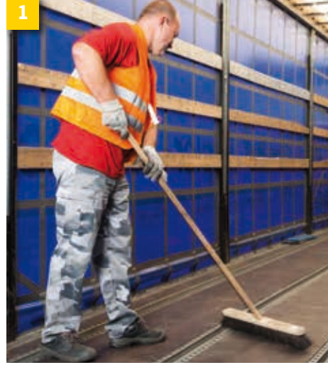
Ön koşul: Uygun bir taşıt (DIN EN 12642 Kod XL) kullanın ve yükleme alanını temizleyin.
