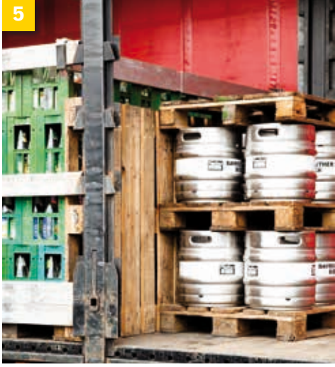
Farklı mallar: Yük treyler üzerinde. Üst varillerin tamamen kendi paletlerinde olmasına dikkat edin.
