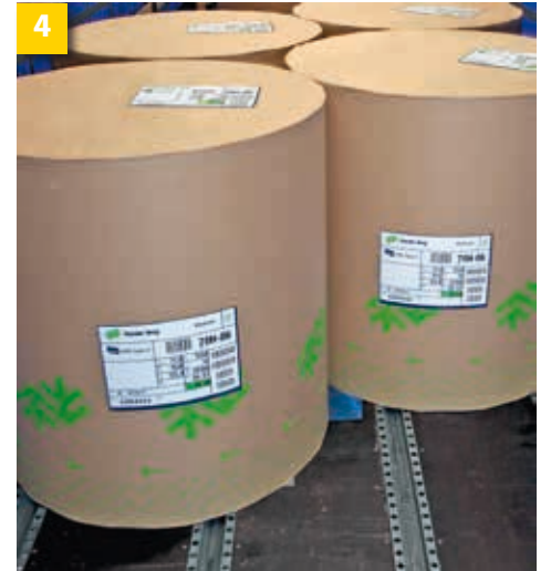
Ruloları aracın boyuna eksenine simetrik olarak yerleştirin. Ruloların birbirlerine temas etmesine dikkat etmelisiniz.
