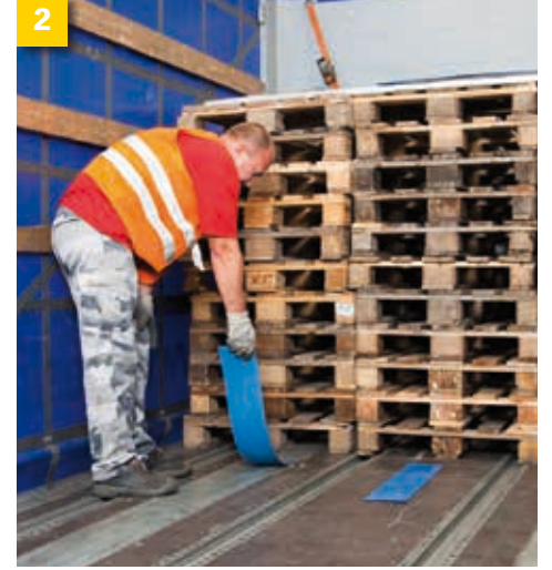
Doğru mesafe: Yük dağılım planına uyulması için boş paletler ön duvarda ara parçası olarak istiflendi.
