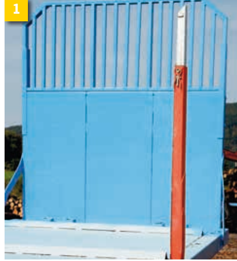
Süpürülerek temizlenmiş bir yükleme alanına, kamalı çubuklara, desteklere ve yeterli büyüklükteki bir ön duvara sahip uygun taşıt (örnek).
