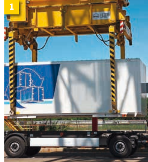
"Değiştirilebilir yük taşıma sandığı (1) veya konteyneri (2) ile kombine yük taşımacılığı": Özel kamyonlar ve römorklar veya özel yarı römorklar, yükleme istasyonuna girişi ve çıkışı üstlenir. Taşımanın (ana taşıma) büyük bölümü demiryolu ile gerçekleşir.
