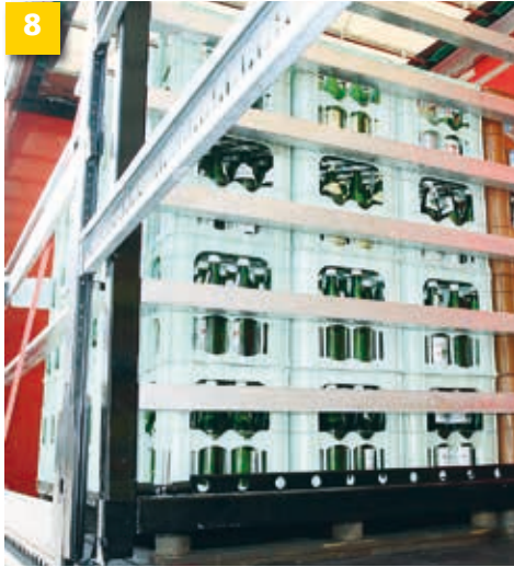
Diğer yük emniyeti varyantı: Delikli raylar vasıtasıyla araç gövdesine bağlanan devirme plakaları ve kilitleme kırışları.
