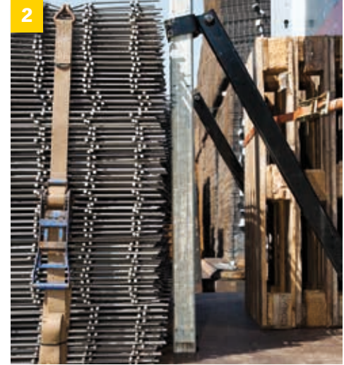
Ek destek: Sürüş yönündeki destekler daha yüksek yük nedeniyle öne doğru ek olarak desteklenir.
