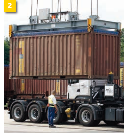
"Değiştirilebilir yük taşıma sandığı (1) veya konteyneri (2) ile kombine yük taşımacılığı": Özel kamyonlar ve römorklar veya özel yarı römorklar, yükleme istasyonuna girişi ve çıkışı üstlenir. Taşımanın (ana taşıma) büyük bölümü demiryolu ile gerçekleşir.
