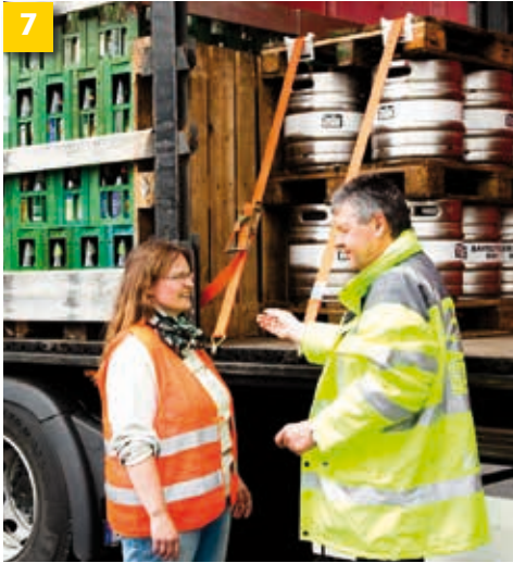
Yapıldı: Yük, branda kapatılabilecek ve taşıt yola çıkmaya hazır olacak şekilde düzgün bir şekilde yüklendi ve emniyete alındı.
