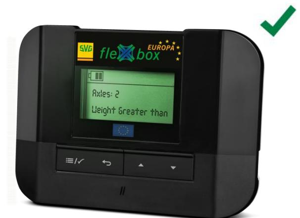
Bild 5 - Beispiel einer intakten OBU
