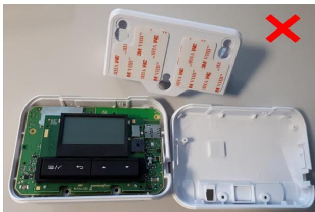
Bild 4 - Beispiel einer beschädigten OBU
